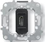
Toma HDMI                                               | 8155.6  | Frontal: Conector 1x HDMI (Tipo A)<br>Trasera: Conexión sin tornillos (20 hilos)<br>Sin garras.<br>Tapa ref. 8655                                                                                                   |
