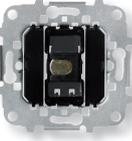
Zumbador | 8119   | 125 / 250 V~ ; 8 VA<br>Tono regulable.<br>Potencia acústica a 1 m. con tapa: 75 dB.<br>Tapa ref. 8529 |
