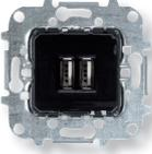
Toma cargador USB doble 1,5A/5V       | 8185   | Tensión entrada: 100 - 240 V AC $\pm$ 10%<br>Frecuencia entrada: 50 - 60 Hz<br>Corriente entrada: 0,20 A AC<br>Tensión salida: 5V DC +5 /-5%<br>Corriente salida: 1500mA compartidos.<br>Compatible con conectores USB A.<br>Tapa ref. 8585   |
