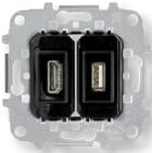
Toma HDMI hembra-hembra + USB                                | 8155.78 | Frontal: Conector 1x HDMI (Tipo A) y Conector 1x USB 2.0 (Tipo A)<br>Trasera: Conector 1x HDMI (Tipo A) a 90° y Conector 1x USB conexión por tornillo (5 hilos).<br>Sin garras. Tapa ref. 8555.1<br>Ver esquemas y dimensiones para determinar compatibilidad con cajas y modo de instalación. |
