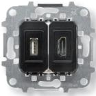
Toma HDMI cableado + USB                                     | 8155.68 | Frontal: Conector 1x HDMI (Tipo A) y Conector 1x USB 2.0 (Tipo A)<br>Trasera: HDMI conexión sin tornillos (20 hilos) y USB conexión por tornillo (5 hilos)<br>Sin garras. Tapa ref. 8555.1<br>Ver esquemas y dimensiones para determinar compatibilidad con cajas y modo de instalación.       |
