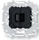
Toma cargador USB A+C<br><b>Nuevo</b> | 8185.1 | Tensión entrada: 100 - 240 V AC $\pm$ 10%<br>Frecuencia entrada: 50 - 60 Hz<br>Corriente entrada: 0,20 A AC<br>Tensión salida: 5V DC +5 /-5%<br>Corriente salida: 18W compartidos.<br>Compatible con conectores USB A y C.<br>Tapa ref. 8585  |
